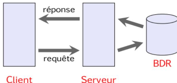
Le logiciel **client** de la machine de l'utilisateur envoie des requêtes au logiciel **serveur** installé sur la machine qui traite les requêtes.
